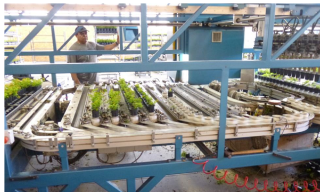
Figure 4. Tuinbouw Technisch Atelier (TTA) Plugsorter grading machine.
